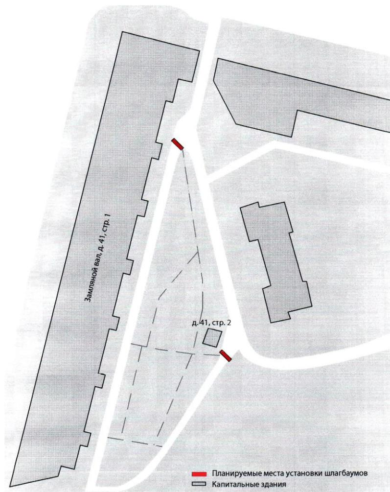
**Тип ограждающих устройств: автоматические электромеханические**
